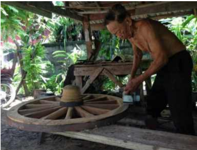
ภาพ กระบวนการขัดแต่งไม้ฝักขามให้เรียบภายหลังการเข้าต้นล้อ โดยพ่อแก้ว รินพล แห่งบ้านน้ำล้อม ตำบลเกาะคา
