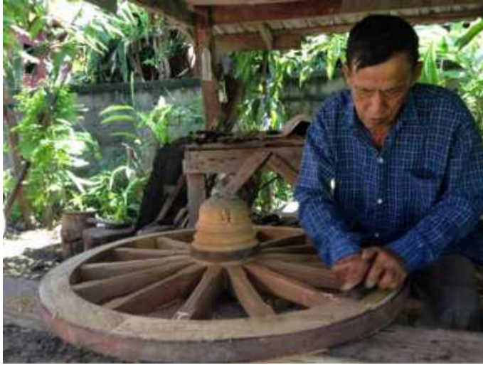
ภาพ ขั้นตอนหลังจากการไสหน้าไม้ ฝักขามแล้วเสร็จ จะเป็นขั้นตอนการเก็บคิ้วขอบล้อ หรือการเซาะร่องขอบล้อเพื่อความสวยงาม โดยพ่อผัด ยะดิน ช่างทำเกวียนรุ่นเก่า แห่งชุมชนบ้านลำปางหลวง
